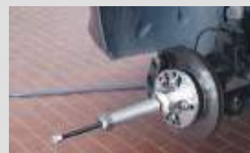
Estrazione dell'albero di trasmissione utilizzando una vite mecaidraulica da 16 ton, cod. GO1016 (optional)
