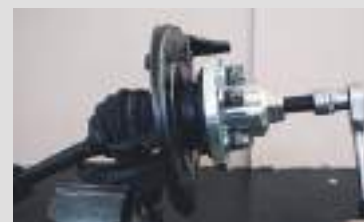
Estrazione meccanica dell'albero di trasmissione a banco
