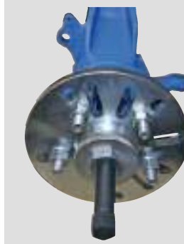
Estrazione albero di trasmissione dal mozzo
