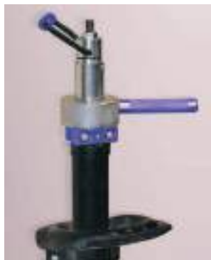
Avvitare il tira-stelo nel supporto e posizionare l'unità sullo stelo dell'ammortizzatore. Fissare lo stelo dell'ammortizzatore al tirastelo con il dado di bloccaggio.
