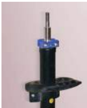
Posizionare il morsetto con le viti di fissaggio. Non serrare.
