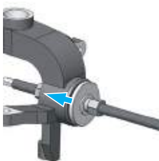
4 Montaggio del nuovo cuscinetto della ruota nel raggio dell'asse
