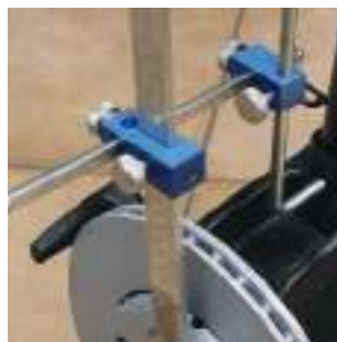
Regolare le aste graduate sino a toccare l'asola di fissaggio ammortizzatore.
