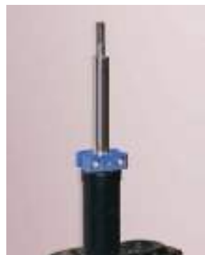
Dopo aver bloccato il morsetto nella sua configurazione finale, rimuovere il tira-stelo. Procedere con il montaggio della molla e rimuovere il morsetto.
