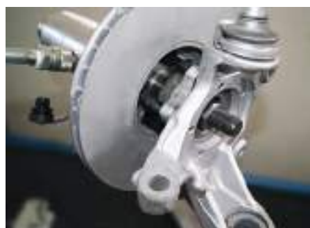
Smontaggio mozzo della ruota con disco del freno - cambio cuscinetto della ruota
