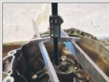
Misurazione della profondità di montaggio K2 (Attenzione: il calibro mostrato non è compreso nella fornitura!)
