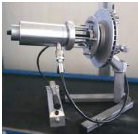
Smontaggio unità cuscinetto ruota - dischi del freno - mozzi ruota - cambio disco del freno
