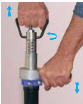
Estrarre il tira-stelo e bloccarlo con una leggera rotazione verso destra o sinistra. NB: Possibilità di estrarre lo stelo di altri 20 mm mantenendo fermo il supporto e ruotando il tira-stelo.
