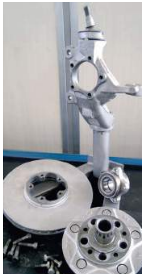
Smontaggio cuscinetto della ruota nel veicolo - cambio cuscinetto della ruota
