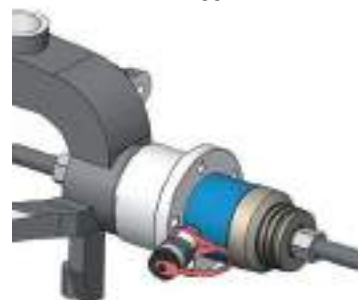
3 Smontaggio del vecchio cuscinetto della ruota dal raggio dell'asse
