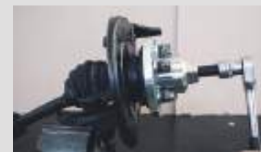
Extraction mécanique de l'arbre de transmission à banc
