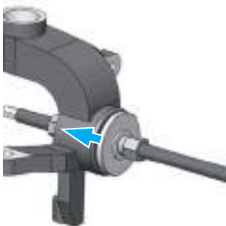
4 Démontage de nouveau roulement de roue du rayon de l'essieu
