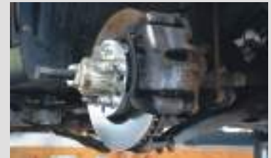
Extraction mécanique de l'arbre de transmission, directement sur la voiture
