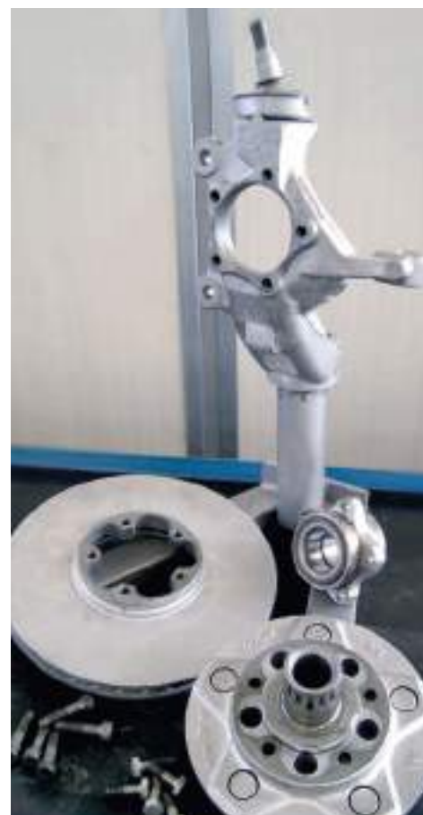
Démontage roulement de la roue dans le véhicule, remplacement roulement de la roue
