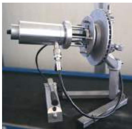
Démontage unité roulement – disque de frein – moyeu roue – remplacement disque de frein
