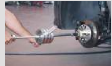
Extraction du moyeu de la roue au moyen de la masse à inertie, Code GO520
