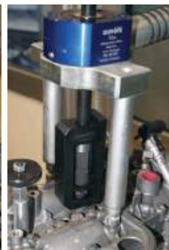
Extraction avec cylindre mecano-hydraulique 12Tonnes GO1015 (en option)
