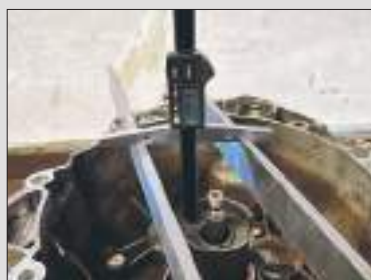
Mesure de la profondeur d'installation K2 (Attention : la jauge n'est pas comprise dans le kit!)
