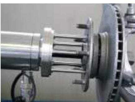
Détacher le disque de frein, remplacement disque de frein
