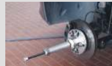
Extraction de l'arbre de transmission en utilisant un vérin mécano-hydraulique 16 tonnes, Code GO1016 (optionnelle)
