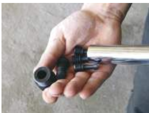
Avec boulons en 5 différentes tailles (rangé dans la poignée)
