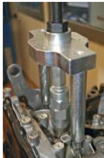
Extraktion mit Schraube
