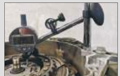
Überprüfung der Höhenfreiheit des DSG- Kupplung
