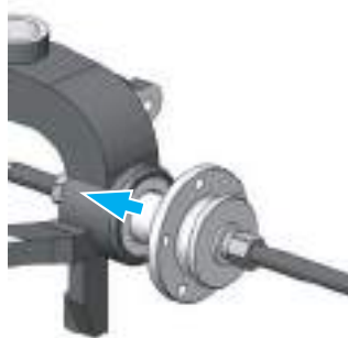
5 Montage der Radnabe
