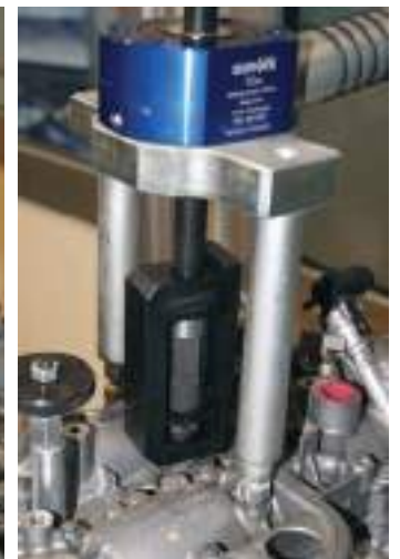
Extraktion mit GO1015 12T mechadraulischer Zylinder (Optional)
