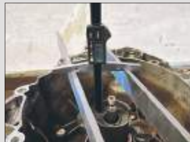
Messung der Einbautiefe K2 (Hinweis: Das abgebildete Messgerät ist nicht im Lieferumfang enthalten)
