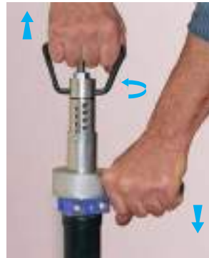
Wenn sich die Anschlagpuffer nicht durch die normale Muskelkraft lösen lassen, kann die Zylinderkolbenstange um weitere 20 mm herausgezogen werden, wobei die Halterung festgehalten und der Stangenspanner gedreht werden muss
