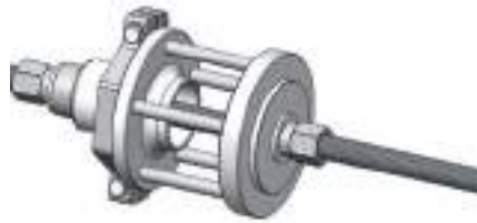
2 Demontage des Radlagerinnenteils Ring von der Radnabe abziehen
