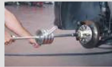
Herausziehen der Radnabe mittels Gleithammer, optionaler Code GO520
