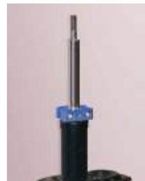
Als letztes wird durch weiteres Heraus-schrauben die Kolbenstangen soweit wie benötigt gezogen und anschließend wieder mit der Klemme fixiert
