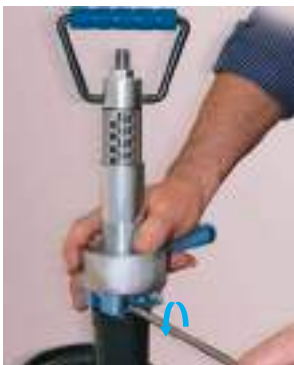
Nach erfolgter Entnahme die Klemme mit den entsprechenden Schrauben blockieren
