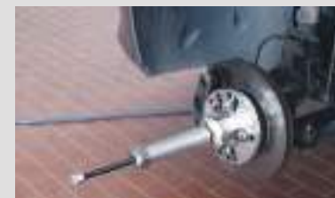
Herausdrücken der Antriebswelle mit einem 16-Ton Mechadraulic-Spindel, optionaler Code GO1016
