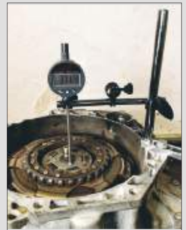
Vertikaler Freiraumtest mit Sonde Verlängerung
