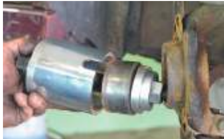
Ausbau des Lagers
