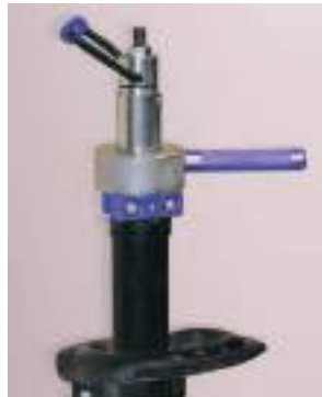
Den Stangenspanner in die Halterung schrauben, die Einheit auf dem Stoßdämpfer positionieren und die Zylinderkolbenstange mit der Befestigungsmutter fixieren
